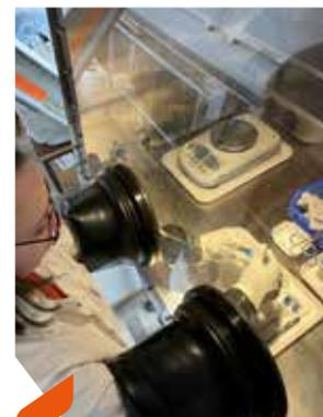
La boîte à gants de l'IJL permet le montage de cellules électro-chimiques dans un espace sans oxygène / Projet CarBioLab Supercondensateur
